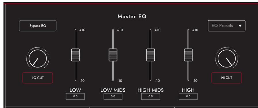
通道均衡器能够单独塑造每个箱体和麦克风组合的音色。可以绕过 EQ 进行快速比较。
