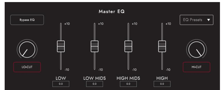
Los ecualizadores de canal proporcionan la capacidad de dar forma al tono de cada una de las combinaciones de pantalla y micrófono de forma individual. El ecualizador se puede anular momentáneamente para una comparación rápida.
