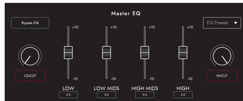
Les égaliseurs de canal permettent de façonner individuellement le son de chacune de vos combinaisons baffle et micro. L'égaliseur peut être court-circuité pour une comparaison rapide.
