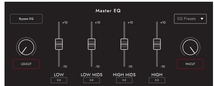
Die Kanal-EQs bieten die Möglichkeit, den Klang jeder Lautsprecher- und Mikrofon-Kombination individuell zu gestalten. Der EQ kann zu Vergleichszwecken auf Bypass geschaltet werden.
