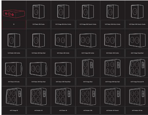
使用选择面板选择您的虚拟箱体。从 23 种不同的扬声器箱中进行选择，或选择 DI（直接注入）作为直接功率放大器输出。
