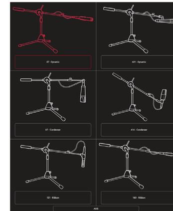
6本の業界標準マイクを選択して、仮想キャビネットにマイキングできます。マイクの軸を切り替えることで、異なる音色を得ることができます。一般的に、OFF AXISは音色を暗くし、中音域のキャラクターをシフトさせます。
