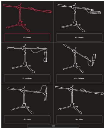
使用 6 个行业标准麦克风选择您的虚拟箱体。切换麦克风选择的轴以获得不同的音色。一般而言，OFF AXIS 会使您的音色变暗并改变中频特征。
