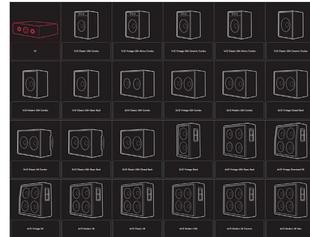
キャビネット選択パネルでバーチャル・キャビネットを選択します。23種類のスピーカー・キャビネットから選択できるほか、パワーアンプを直接出力するDI(ダイレクト・インジェクション)も選択可能です。
