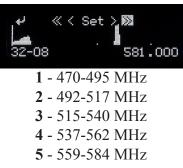
6 - 581-606 MHz 7 - 603-628 MHz 8 - 626-651 MHz 9 - 648-673 MHz 10 - 669-694 MHz
