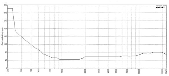
AH66-12T-BSG Vertical Beamwidth (( -6dB)
