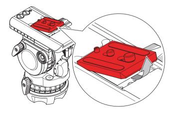
Befestigen Sie die Kameraplatte ungefähr im Schwerpunkt der Kamera. In der verschiebbaren Balanceplatte sind zusätzliche Schrauben vorhanden.
