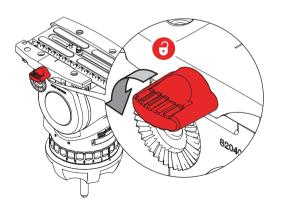
3. Drücken Sie den roten Verriegelungshebel nach vorne und nehmen Sie die Kameraplatte ab.
