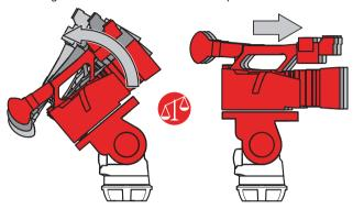
(c) Kippt die Traglast nach vorne (Kamera zeigt nach unten), schieben Sie die Kamera in Richtung der Rückseite des Fluidkopfes. Verriegeln Sie die verschiebbare Balanceplatte wieder.
