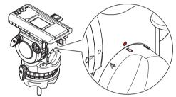
Neigen Sie die Traglast in beiden Richtungen um ca. 30° und lassen Sie die Kamera los. Bleibt die Kamera nach Freigabe in derselben Position, ist die Traglast korrekt ausbalanciert.
