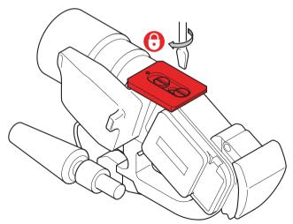
6. Montieren Sie die Kameraplatte und Kamera auf die verschiebbare Balanceplatte. Sie rastet automatisch ein und der Verriegelungshebel schnellt hörbar in seine Ausgangsposition zurück.
