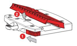
4. Befestigen Sie die Kameraplatte ungefähr im Schwerpunkt der Kamera. Beachten Sie die angegebene Pfeilrichtung unterhalb der Skala bzw auf der Unterseite der Kameraplatte.
