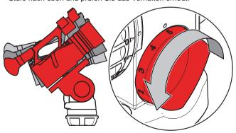
5. Neigen Sie die Traglast durch positive und negative Wirkrichtungswinkel und überprüfen Sie, dass die Traglast ohne Unterstützung in jedem beliebigen Neigungswinkel bleibt.
