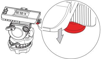
**3.** Schieben Sie mit nach unten gedrücktem Sperrknopf den Verriegelungshebel bis zum linken Anschlag.
