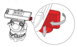
**4.** Sie können die Kameraplatte oder Kamera von der verschiebbaren Balanceplatte nehmen.
