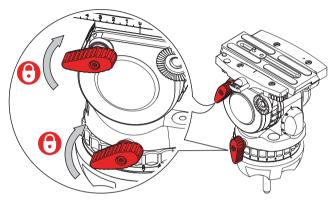
2. Öffnen Sie die Klemmung der Kameraplatte.
