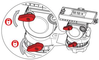
2. Halten Sie die Kameraplatte oder Kamera mit der einen Hand fest. Greifen Sie den Verriegelungshebel mit Daumen und Zeigefinger der anderen Hand und ziehen Sie den Sperrknopf nach unten.
