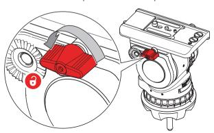
(b) Kippt die Traglast nach hinten (Kamera zeigt nach oben), schieben Sie die Kamera in Richtung der Vorderseite des Fluidkopfes. Verriegeln Sie die verschiebbare Balanceplatte wieder.
