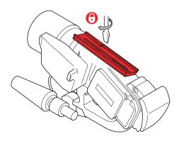
5. Die Kameraplatte wird schräg in die Plattform eingesetzt und dann nach unten gedrückt, wobei die Rastklaue hörbar einrastet. Die Kameraplatte ist nun sicher befestigt.
