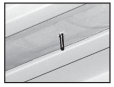
Fig. 12: Installed hanger bolt.
