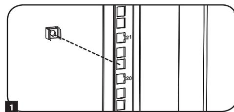
**2** Вставить один из фланцев закладной гайки в квадратное отверстие с внутренней стороны монтажной направляющей. Нажать на нее, чтобы выровнять с краем квадратного отверстия. Каждый фланец должен находиться с боковой стороны квадратного отверстия, а не вверху или внизу.
