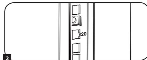
**3** Слегка сжать закладную гайку по бокам, чтобы оставшаяся часть фланца прошла в квадратное отверстие. Когда закладная гайка установлена правильно, оба фланца будут проходить насквозь через квадратное отверстие и будут видны на внешней стороне монтажной направляющей. Повторить шаги 1-3 для установки всех необходимых закладных гаек.
