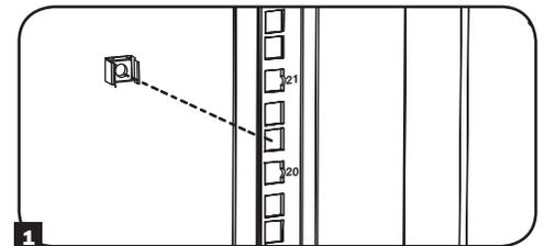
**2** Desde la parte interior del riel de montaje, inserte una de las bridas de la tuerca de jaula a través de la abertura cuadrada. Presiónela contra el lado de la abertura cuadrada. Cada brida debe engancharse en un lado de la abertura cuadrada, ni arriba ni abajo.
